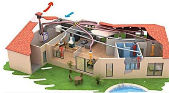
Schema di ventilazione meccanica controllata centralizzata con relativa canalizzazione
