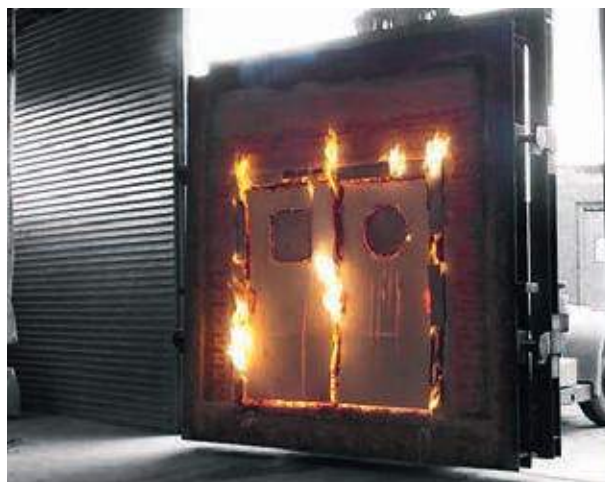
Esempio deformazione a caldo dell'anta
